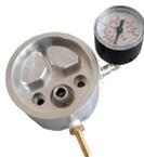
Base d'accueil connectée en permanence au réseau d'air comprimé de l'atelier pour mettre sous pression Ditybox (maxi 8 bars) en moins de 2 secondes.
